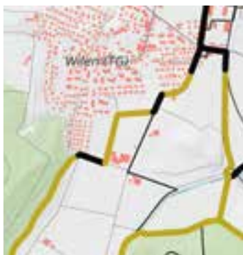
La carta dettagliata consultabile sul geoportale del Canton Turgovia (geo.tg.ch) distingue tra i tipi di rivestimento (verde oliva: naturale; nero: duro).
